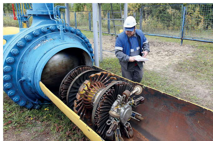
Путь по трубе поршень проходит за 12 часов
